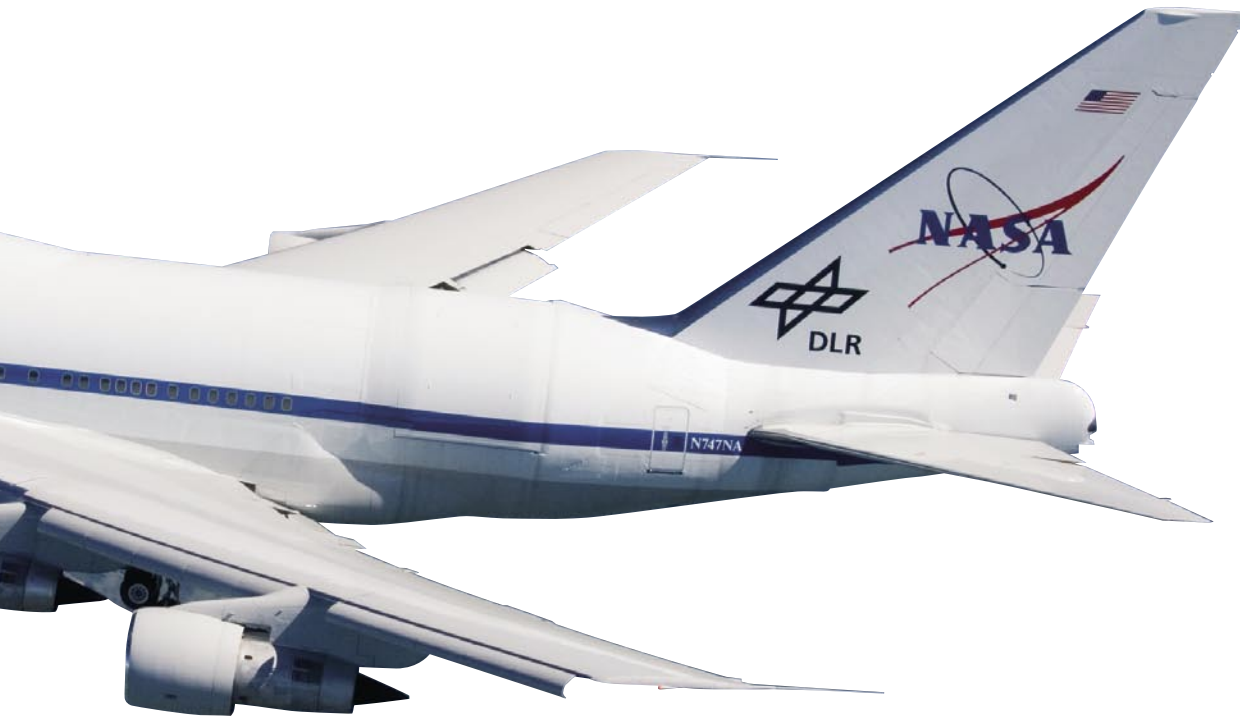
▲ テスト飛行中のボーイング 747SP。SOFIA 赤外線望遠鏡は機体後部に設置されます。
